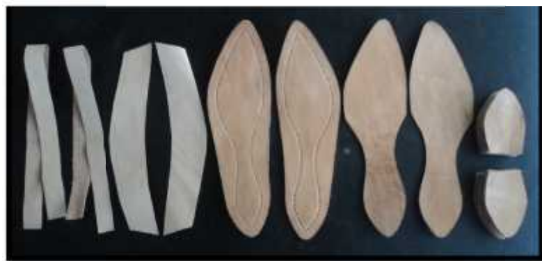
Gambar 6. Kulit yang sudah dipotong sesuai ukuran pola, dari kiri kekanan: bagian tali jepit, mukaan , lemek /sol atas, sol tengah dan hak (Foto: Amrizal, 2015)
