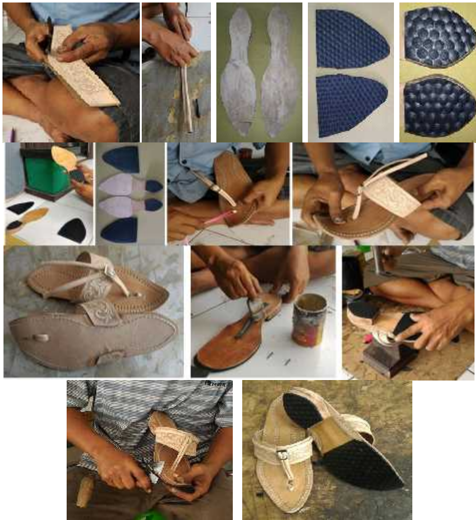
Gambar 7. Prose menyiapkan Mukaan/Atasan, sol, setengah sol, tumit/hak, merangkai sol luar dengan hak, merangkai sol atas/sol dalam dengan muka memasang tamsin dengan sol tengah, merapikan bagian sisi-sisi sol Tarompa Datuak dan sampai Finishing (Foto: Amrizal, 2015)
