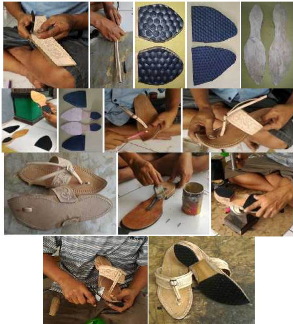
Gambar 7. Prose Pembuatan Mukaan/Atasan Tarompa Datuak sampai Finishing (Foto: Amrizal, 2015)
