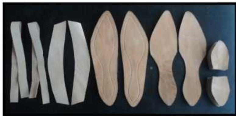
Gambar 6. Kulit yang sudah dipotong sesuai ukuran pola, dari kiri kekanan: bagian tali jepit, mukaan , lemek /sol atas, sol tengah dan hak (Foto: Amrizal, 2015)
