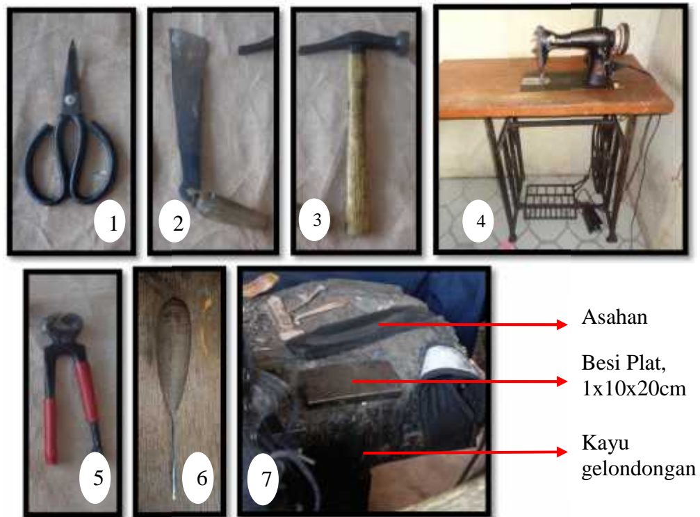
Gambar 4. Alat Untuk Pembuatan Tarompa Datuak : (1) Gunting, (2) Pisau Siset, (3) Palu Besi, (4) mesin Jahit Hitam, (5) Catok, (6) Jarum, dan (7) Kayu Gelondongan, Besi Plat dan Asahan/Pengasah Pisau Siset (Foto: Amrizal, 2015)
