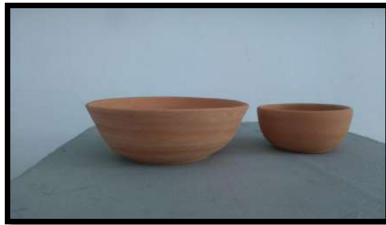
Gambar 12. Sampel karya keramik (mangkok dan souvenir) dari tanah liat Parit malintang yang dibuat dengan teknik putar padat setelah dibakar biskuit.
