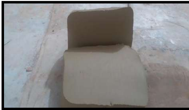
Gambar 7. Kondisi tanah liat Parit Malintang yang sudah diolah dan diuli, terlihat tekstur tanah cukup halus.
