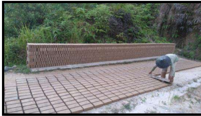
Gambar 2. Proses penjemuran batu bata di Parit Malintang
