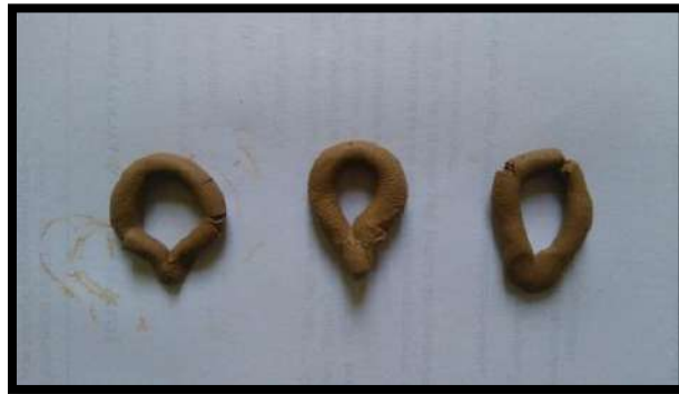
Gambar 6 . Cincin-cincin tanah liat Parit malintang yang bercampur pasir gunung untuk menguji plastisitas, terlihat masih terdapat retakan.
