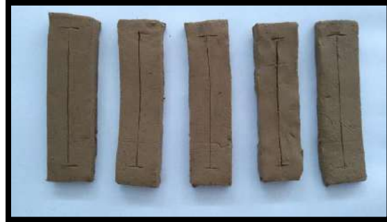
Gambar 9. lempengan lempengan tanah liat untuk menguji persentase susut kering dan susut bakar.
