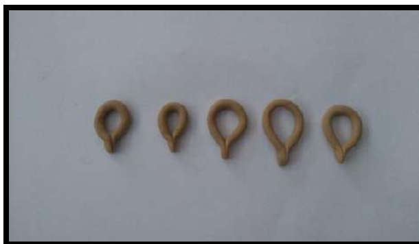
Gambar 8. Cincin-cincin tanah liat Parit malintang untuk menguji plastisitas, dalam gambar ini terlihat tidak terdapat retakan pada body cincin
