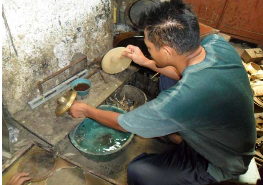
Gambar 16. Pemisahan talempong setelah dicelupkan pada cairan lilin (Foto: Dok. Andar 2015)
