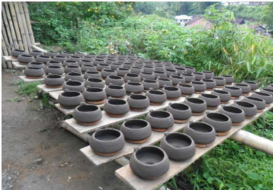
Gambar 19. Pelapisan cetakan talempong dengan tanah liat (Foto: Dok. Andar 2016)
