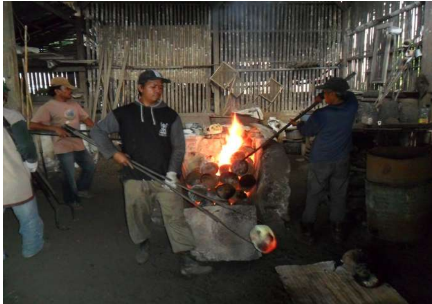
Gambar 21. Mengeluarkan cetakan talempong yang sudah dibakar (Foto: Dok. Andar 2016)
