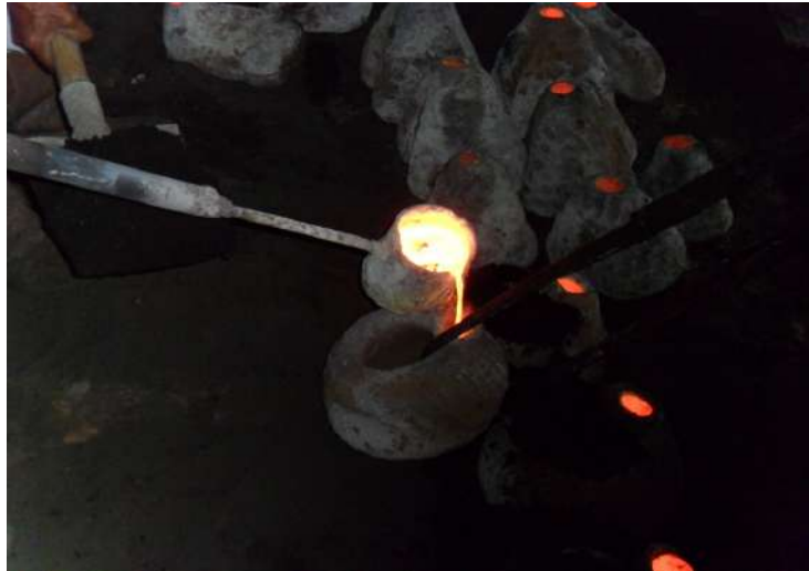
Gambar 22. Penuangan cairan logam pada cetakan talempong (Foto: Andar 2015)
