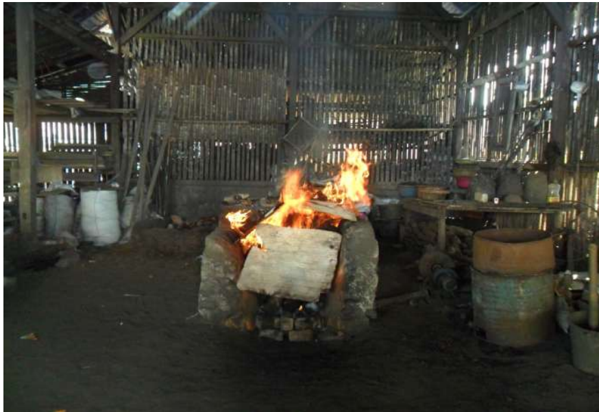
Gambar 20. Pembakaran cetakan talempong dan peleburan logam (Foto: Dok. Andar 2016)
