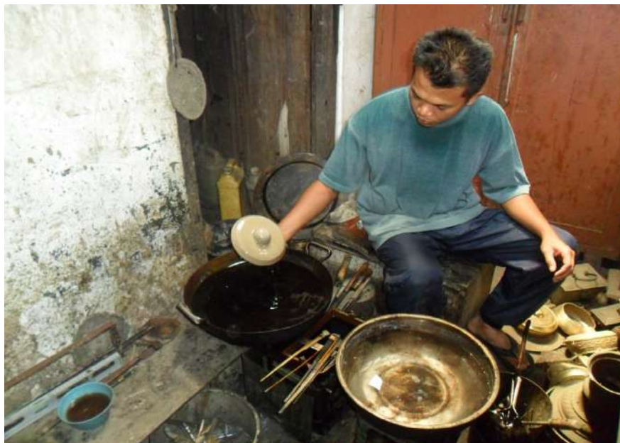
Gambar 15. Pembuatan talempong lilin bagian atas (Foto: Dok. Andar 2015)
